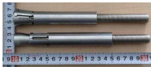
写真1 あと施工アンカーの全景
